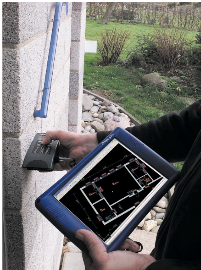
Der Einsatz modernster Geräte vor Ort wie Handlasermeter und Handheld PC sichert die rationelle Erfassung grafischer wie numerischer Daten.
